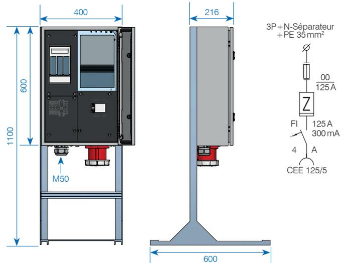
Tableau de comptage 125 A tôle d'acier IP55 sur support, FI type B
