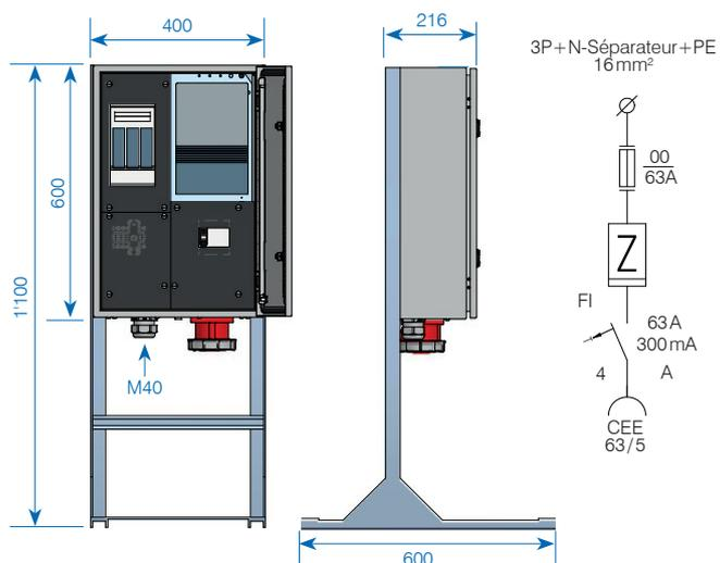
**Tableau de comptage 63A tôle d'acier IP55 sur support, FI type B**
