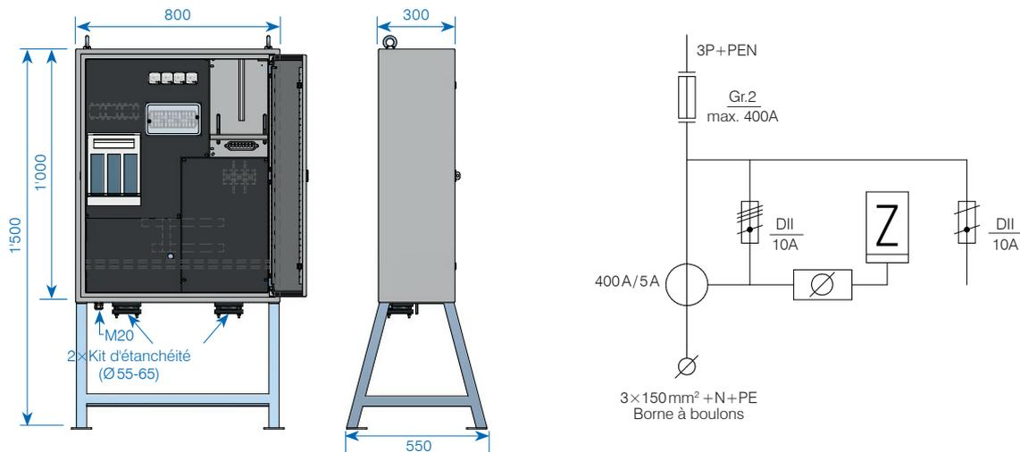
Tableau de comptage 630 A tôle d'acier IP54 avec anneaux de transport, sur support
