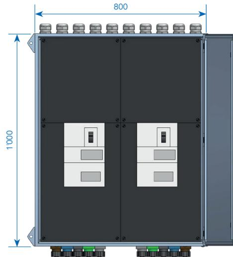
**N° art.: 147022** Ensemble de connecteurs 400A/200A/63A dans une armoire en tôle d'acier avec prises enfichables unipolaires PowerSAFE avec connecteur de puissance 400A 4P 50kA avec déclencheur électrique et FI 300mA, prise CEE avec sécurité FI et LS, degré de protection IP44.
