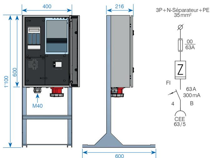
**Tableau de comptage 63A tôle d'acier IP55 sur support**
