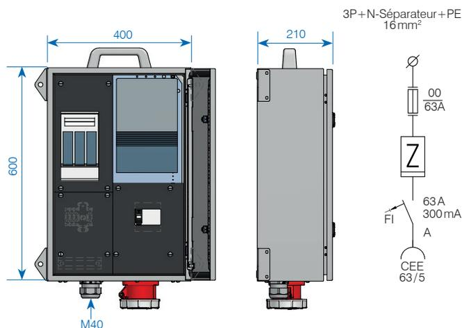
**Tableau de comptage 63A tôle d'acier IP55 sur support, FI type A**
