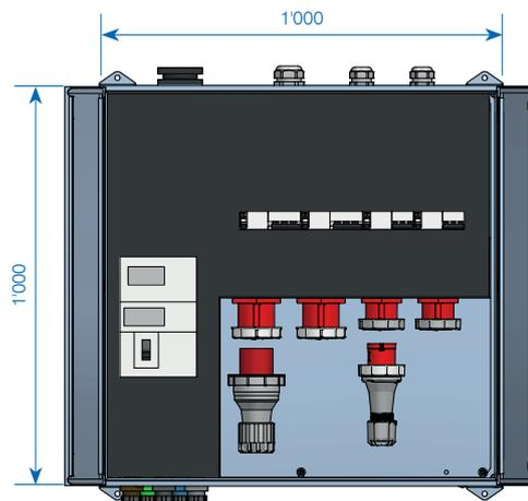
**N° art.: 254700** Ensemble mobile de connecteurs 400A dans une armoire en tôle d'acier avec entrée et sortie par prises enfichables unipolaires PowerSAFE. Connecteur principal et transformateur de courant 400A et prise CEE avec sécurité NH, degré de protection IP44.
