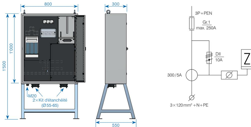
Tableau de comptage 400 A tôle d'acier IP54 avec anneaux de transport, sur support
