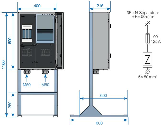
Tableau de comptage 125 A tôle d'acier IP55 sur support, FI type A
