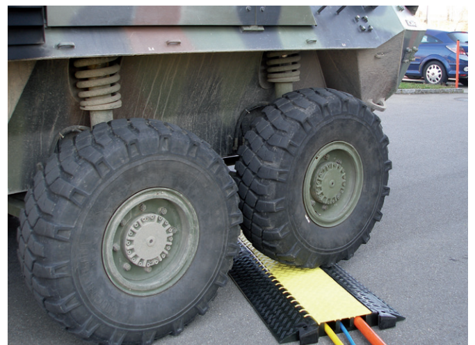
Test di carico con Piranha
