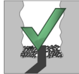
mit Entwässerungsleitung (z.B. fester Untergrund)
