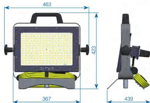
Der Hochleistungsstrahler AlphaLUXX wird standardmässig mit einem Montagebügel geliefert. Zur Optimierung für verschiedene Einsatzmöglichkeiten hat GIFAS einen Ständer mit Befestigungszapfen entwickelt. Dieser ermöglicht ein einfaches und schnelles montieren auf den Ständer. Ebenso bietet dieser Ständer einen zweiten Nutzen, indem die AlphaLUXX einfach auf dem Boden platziert werden kann.
