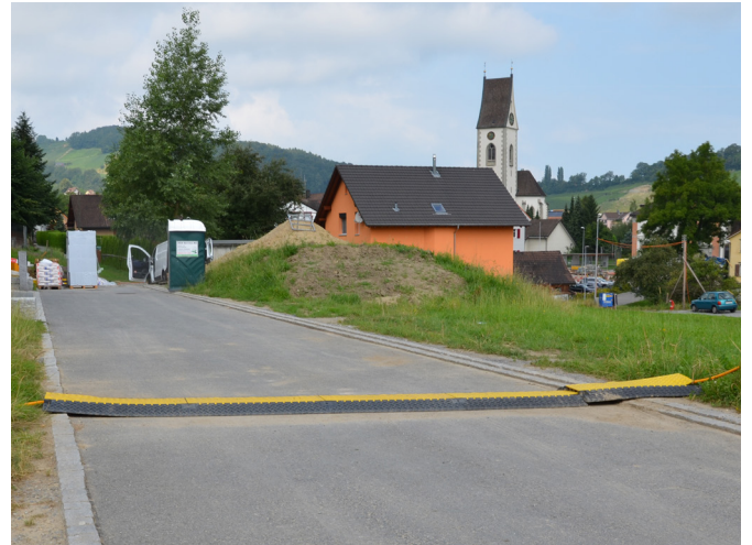
Pont de câble
