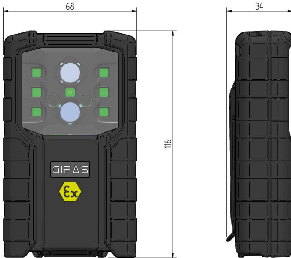
Illustrazione 6: Dimensioni TorchLED 2 Ex
